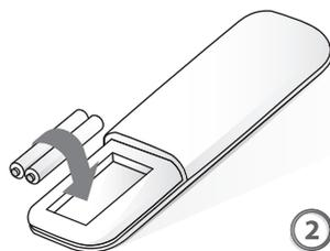
Instale duas pilhas novas (7#), e posicione as pilhas nos polos elétricos corretos (+ e -).
