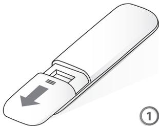
Schieben Sie, um die Abdeckung gemäß der durch die Pfeilspitze angegebenen Richtung zu öffnen.
