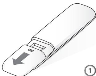
Schuif het deksel open in de aangegeven richting.
