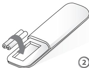
2 Sostituire le batterie solo con pile nuove del tipo AAA - LR03 1.5V, verificando che la posizione dei poli + e - sia corretta.
