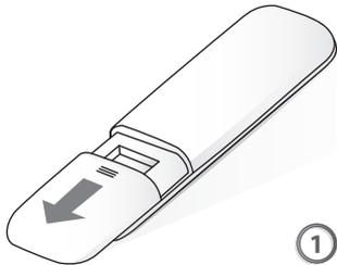
Deslice para abrir la tapa según la dirección indicada por la punta de la flecha.
